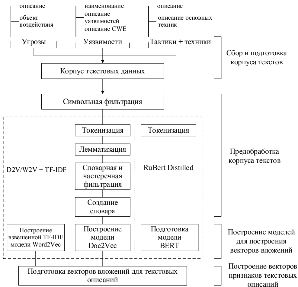
Рис. 5. Схема подготовки текстовых описаний угроз, уязвимостей, техник (тактик) и их формализации на основе векторных вложений
