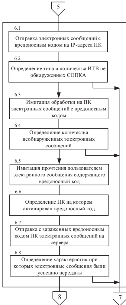
Рис. 3. Последовательность функционирования блока моделирования компьютерной атаки типа «Phishing» на локальную сеть
