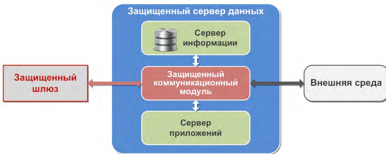
Рис. 7. Состав и принцип работы бортового защищенного сервера
