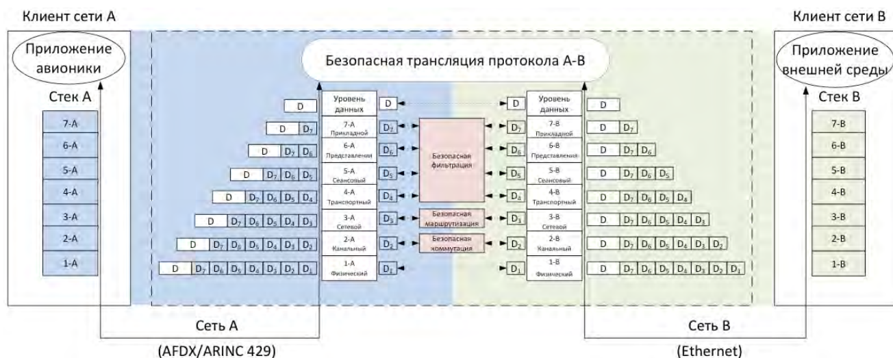
Рис. 6. Принцип работы бортового защищенного шлюза
